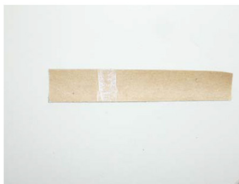
Fig 3. Fotografías de muestras de papel abrasivo que presentan: a) un depósito de polvo denso, calcáreo blanco; b) un ligero depósito de polvo
